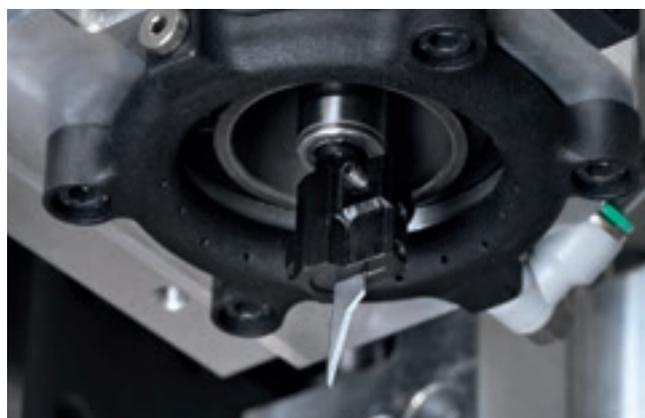
**Le dispositif souffleur pour unité de coupe** permet de réduire la surchauffe de la lame et l'endommagement conséquent de certains types de matériaux, tout en garantissant le nettoyage de la zone de coupe des poussières et autres déchets de façonnage.
