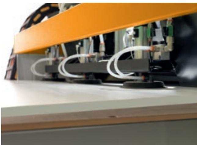
La technologie des ventouses à chargement indépendant et avec des systèmes de détachement offre une flexibilité à la charge unique sur le marché.
