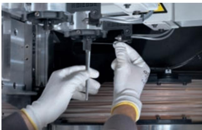
**Le changement de lame est extrêmement simple et rapide**. Quelques opérations suffisent à l'opérateur pour changer la lame, ce qui limite les temps d'arrêt de la machine.
