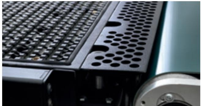
Le système d'aspiration des copeaux placé entre la machine et le tapis de déchargement garantit la plus grande propreté des pièces.
