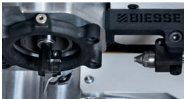
**Système de lubrification d'outil pour découpe** permet le meilleur déplacement de la lame au sein des matériaux particulièrement denses ou élastiques grâce à un système de nébulisation air-huile qui assure la lubrification de l'outil durant la coupe.
