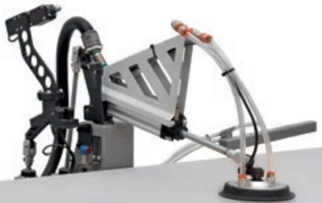
Le nouveau système d'alignement gère le détachement et le chargement aligné des matériaux respirants et/ou fins jusqu'à 3 mm d'épaisseur ou fortement collés.
